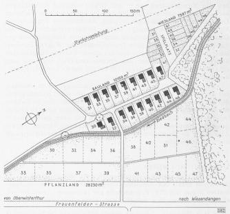
Bild 2. Lageplan mit Nummerierung der zusammengehörigen Parzellen, Masstab 1:4000
