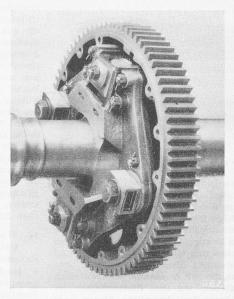
Bild 19. Kupplung zwischen Hohlwellen-Zahnrad und Triebachswelle (Universalantrieb SLM)
