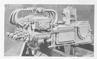
Bild 17. Dreizylinder-Gleichstrom-Dampfmotor
