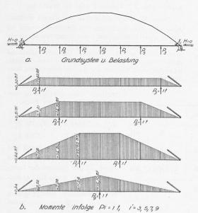
Bild 47. Hochpressen der Fahrbahn
