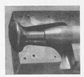
d Diffusor-Tellerventil Ventilsitzwinkel 35°
