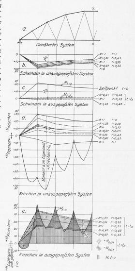
Bild 48. Biegungsmomente im Versteifungsträger für Schwinden und Kriechen
