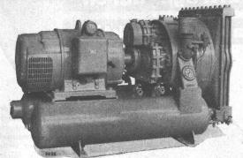
Luftgekühlter Baukompressor 4,5 m³ pro Min.
