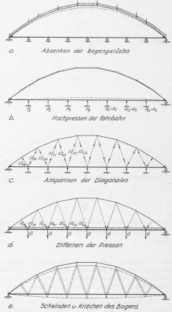
Bild 41. Schema des Ausrüstungs-Vorgangs
