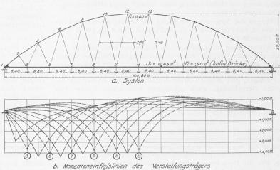
Bild 40. Träger von > 100 m Spannweite nach System Ayuthia
