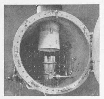
Bild 11. Rauchkammer, HD-Vorwärmer-Elemente, Blasrohr
