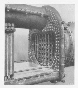
Bild 3. Russbläser für Hoch- und Niederdruck-Rauchgas-Speisewasservorwärmer
