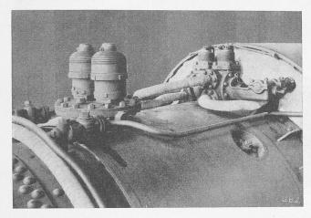
Bild 10. HD-Sicherheits-Ventile, Regulator, ND-Sicherheitsventile
