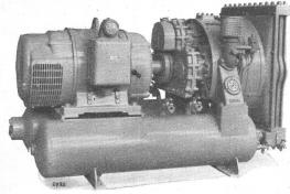
Luftgekühlter Baukompressor 4,5 m³ pro Min.
