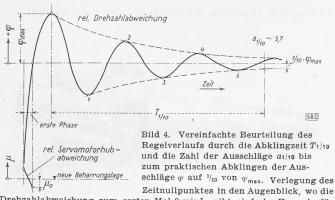
Drehzahlabweichung zum ersten Mal 0 wird, gibt einfache Formeln für die Uebertouren.
