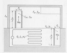
Bild 24. Zur Berechnung der Luftheizung der Wäschereihalle
