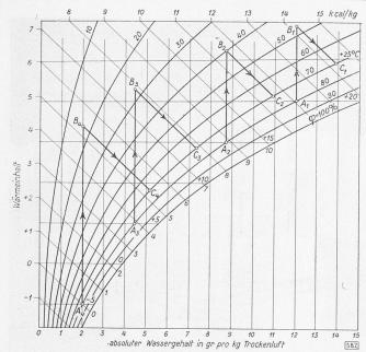
Bild 23. Zustandsänderungen der Luft im Trockenraum A Aussenluft, B bei Trockenraumeintritt, C bei Austritt
