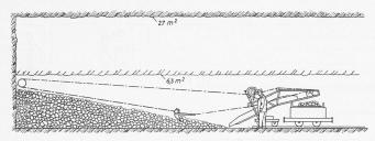
Bild 14. Verladeschrapper, der 1931/32 im Unterwasserstollen des Krängedewerks in Schweden verwendet wurde
