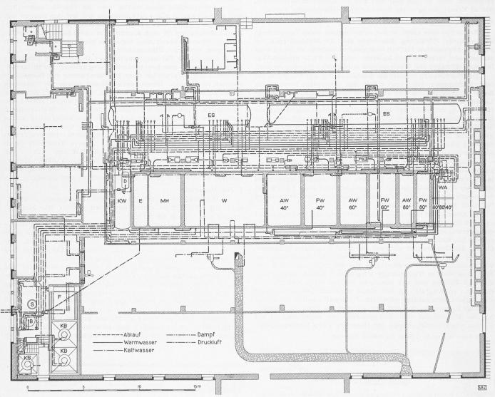
Bild 14. Leitungsschema. AW Abwasser, B Basenaustauscher, D Druckluftbehälter, E Enthärtetes Wasser, ES Elektro-Speicher, F Filter, FW Frischwasser, KB Klärbehälter, KW Kondenswasser, KS Kalksättiger, MH Mittelhartes Wasser, S Salzgefäss, W Weichwasser 0° fr. WA Wärmeaustauscher
