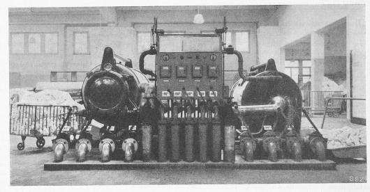
Bild 9. Verteil- und Sammelbatterie eines Waschmaschinenpaares
