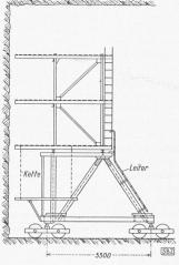
Bild 11. Vierstöckiges Bohrgerüst für den Järp-Ström-Tunnel (Bild 4). 1:100
