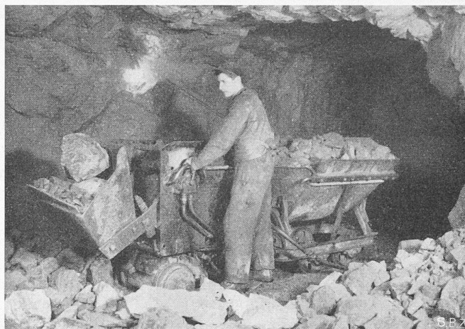
Bild 12. Lademaschine «Atlas-Diesel» mit Schaufel für 1/8 m³
