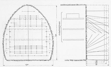
Bild 4. Unterwasserstollen des Järp-Ström-Kraftwerks in Schweden, 1:200
