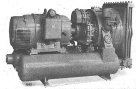
Luftgekühlter Baukompressor 4,5 m³ pro Min.
