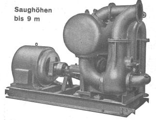
Leistungen 1 bis 500 Liter/Sek. Kein Bodenventil. Keine Klappe im Saugstutzen. Keine Hilfs-Vakuum-Pumpe. Jederzeitiges automatisches Ansaugen auch nach Lufteintritt im Saugrohr. Keine reibenden, sich abnützenden Dichtungsflächen, daher unempfindlich, gegen Sand, Schlamm und Kies.
