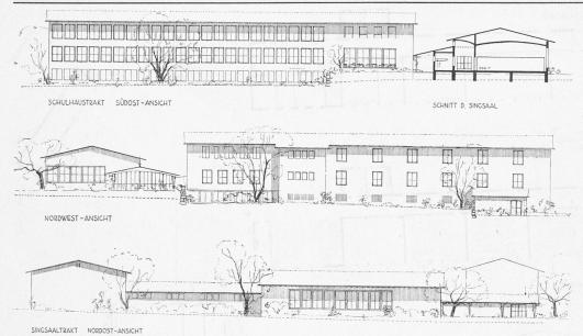
Bild 6. Schulhausanlage in Pfäffikon, Kanton Zürich. Fassaden 1:600
