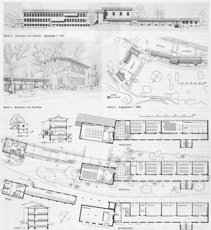
Bild 2. Sekundarschulhaus Wetzikon. Grundrisse und Schnitte. Arch. PAUL HIRZEL, Wetzikon. — Masstab 1:700
