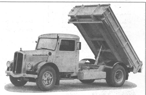
8-81/2 t Dreiseltenkipper, Typ 2 CR1D, mit 4 Zylinder, 65 PS. Dieselmotor, 27,1 Steuer-PS.
