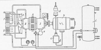
Bild 2. Funktionsschema der Druckluftanlage nach Bild 4. I Kompressorzylinder erste Stufe, II Kompressorzylinder zweite Stufe, a Kühlluftaustritt, b Drehstrommotor für vier Spannungen, c Handschaltkasten, d Dreipoliger Stecker für Kabelanschluss, e Aussetzerregler mit Vorsteuerung, f Zwischenkühler, g Nachkühler, h Kühlluftventilator, i Druckluftbehälter, k Sicherheitsventil
