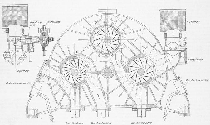
Bild 3. Querschnitt durch den dreizylindrigen Kompressor nach Bild 5, Masstab 1:6
