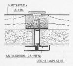
Bild 6. Horizontalschnitt durch Aussenwand, 1:6
