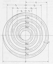
Bild 2 (links) Spiralfeder
