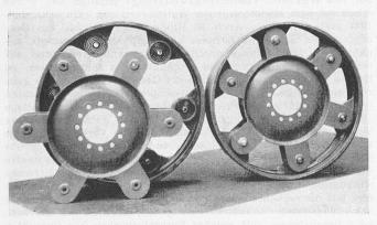
Bild 7. Gefedertes Rad der SLM Winterthur Bild 8 (rechts). Fahrbarer Kompressor der SLM auf gefederten Rädern
