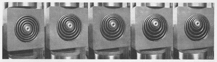
Bild 1. Spiralfeder unter radialer Last
