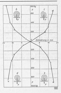
Kurven zum schnittweisen Entwurf von Spiralfedern Bild 4. Beginn bei der äussersten Windung Bild 5. Beginn b
