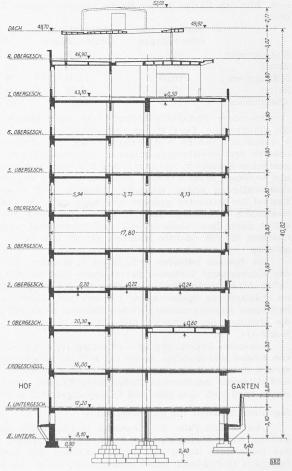
Bild 37. Bettenhaus, Querschnitt Eisenbetonkonstrukt. 1:350
