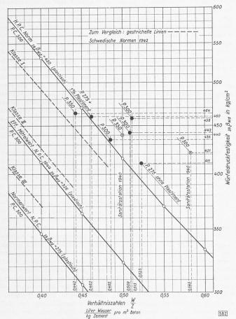
Bild 41. Würfeldruckfestigkeit in Funktion des Verhältnisses W/Z, Zusammenstellung der Mittelwerte von Bettenhaus und Sanitätsstation. Volle Kurven von Dr. A. Voellmy, EMPA Zürich, 1945 nach Feret berechnet, mit Sicherheitsfaktor 0,9 versehen, Porenvolumen  $1^{\circ}$
