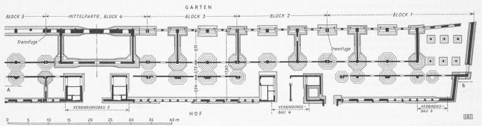
Bild 39. Bettenhaus, westliche Hälfte, Fundamentplan 1:500. Anschraffiert sind jene Fundamente, die Windlasten auf den Baugrund übertragen
