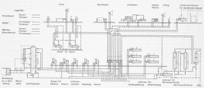
Bild 47. Vereinfachtes Schaltbild der Apparate in der Wärmezentrale
