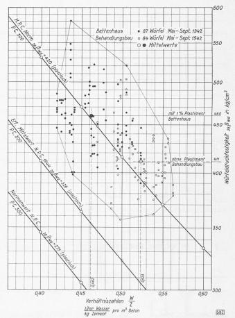
Bild 40. An Probewürfeln ermittelte Festigkeiten in Abhängigkeit vom Verhältnis W/Z, vibrierter Beton P. C. 275. Kurven von Dr. A. Voellmy, EMPA Zürich, 1945 nach Feret berechnet, mit Sicherheitsfaktor 0,9 versehen, Porenvolumen 1%
