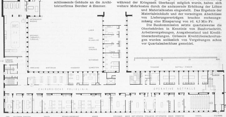
Bild 25. Behandlungsbau, Erdgeschoss, östliche Hälfte: Chirurgische Poliklinik. Grundriss 1:400
