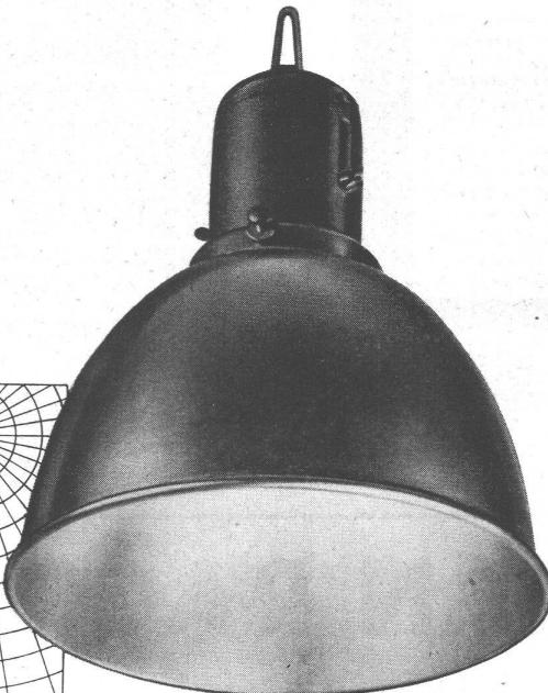
Dieser ALUMINIUM-LICHT-Reflektor ist die neuzeitliche Armatur für Betriebsbeleuchtungen aller Art. Innen matt alzaciert, ergibt er bei entsprechender Aufhängehöhe ein blendungsfreies Licht. Da er sowohl auf Breit- als auch auf Tiefstrahlung eingestellt werden kann, eignet er sich gleichermaßen für Allgemein- wie für Arbeitsplatzbeleuchtung. Er ist in Größen von 14,5 bis 41,5 cm Durchmesser und für Glühlampen von 40 bis 2000 Dlm lieferbar.
