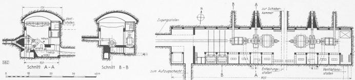
Bild 10. Zentrale Luzzone, Maschinensaal 1:800
