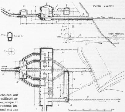
Bild 9. Zentrale Luzzone, allgemeine Anordnung 1:1500 a Schieberkammer, b Maschinensaal, c Reservoir, d Druckschacht, e Ablaufstollen zum Stausee, f Ventilationsstollen, g Verbindungsstollen zu h, h Aufzugschacht, i Kaverne für Zubringerpumpen, k Saugleitung für Zubringerpumpen, l Saugleitungen für Speicherpumpen, m Ablaufstollen nach dem Luzzonetal
