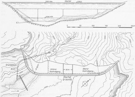
Bild 4. Staumauer Camona, Grundriss und wasserseitige Ansicht 1:4000; Querschnitt 1:2000
