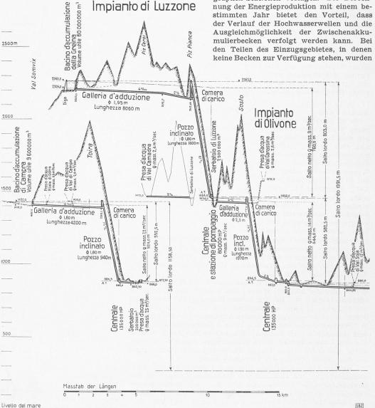
Bild 2. Längenprofil der Kraftwerke. Masstab der Längen 1:175000
