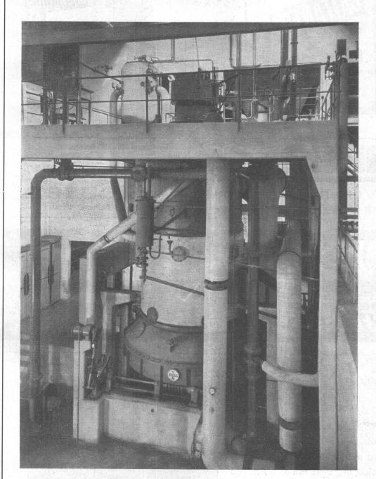
"VOGO" Drehrostgaserzeuger für eine Maximalleistung von 3 000 000 kcal/h Amtlich geprüfte Anlage durch die Eidgen. Materialprüfungs-Anstalt Zürich
