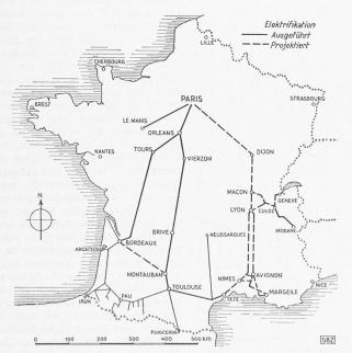
Bild 1. Elektrifizierte und zur Elektrifikation vorgesehene Vollbahnstrecken in Frankreich. Masstab  $1:12\,000\,000$
