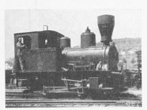
Bild 15. Kleinlokomotive mit Funkenfänger für Holzfeuerung
