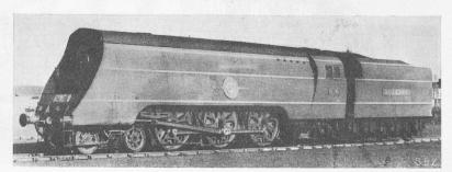
Bild 1. 2C1-Lokomotive «Merchant Navy» der Southern Railway
