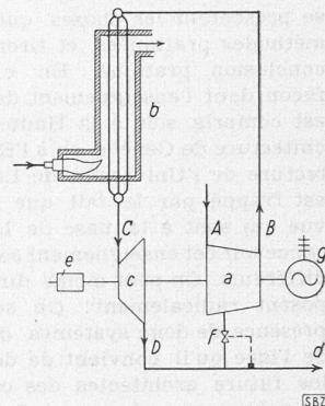
Bild 22. Schema einer Heizkraft-Luftturbine mit gleichzeitiger Stromerzeugung.
