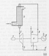
Bild 22. Schema einer Heizkraft-Luftturbine mit gleichzeitiger Stromerzeugung.
