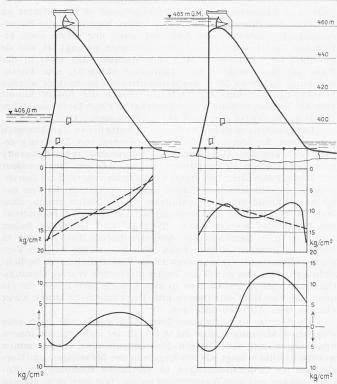
Bild 7. Gemessene Spannungen in der Basisfläche des Hiwassee-Dam, links bei leerem, rechts bei gefülltem Stausse. Oben: Vertikale Druckspannungen, gestrichelt nach Berechnung, ausgezogen nach Messung. Unten: Schubspannungen
