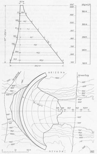
Bild 1. Boulder-Dam. Oben: Querschnitt an der tiefsten Stelle Unten: Grundriss, Masstab 1:4000
