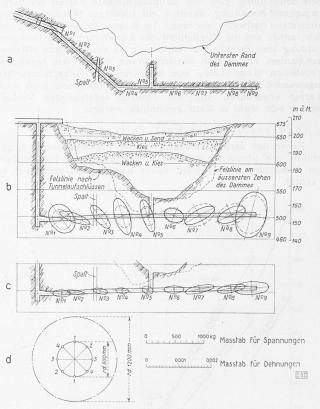
Bild 3. Spannungsmessungen am Boulder-Dam.
