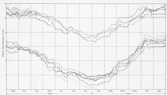
Bild 9. Assuan-Dam, Aegypten. Zeitlicher Verlauf der Relativverschiebungen zwischen Mauer und Stützpfeilern in mm. Oben acht Pfeiler von 14,2 m Höhe; unten 15 Pfeiler von 26,7 m Höhe
