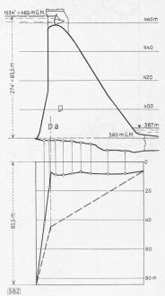
Bild 4. Auftriebsmessungen am Hiwassee-Dam
