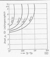
Bild 8. Zum Selbstfahren nötiger Anfangsdruck in Abhängigkeit von  $t_C$ ,  $\eta_T$  und  $\eta_K$  für  $\varepsilon_1=\varepsilon_2=0.10$
