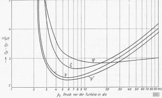
Bild 5.  $\eta_K\,\eta_T\,T_C/T_A$  in Abhängigkeit des Druckes vor der Turbine.  $\zeta$  für Schaltung nach Bild 1.
