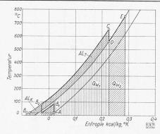
Bild 12. Entropiediagramm mit Zwischenkühlung des Kompressors
