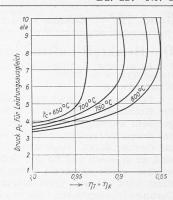
Bild 6. Zum Selbstfahren nötiger Anfangsdruck in Abhängigkeit der Turbinen-Eintrittstemperatur  $t_C$  und der Wirkungsgrade  $\eta_T$  und  $\eta_K$  für Schaltung nach Bild 1.
