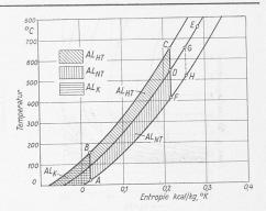
Bild 10. Entropiediagramm bei Einbezug der Verbrennungsluft
