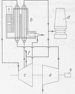
Bild 9. Schema der vorgeschlagenen Heizkraft-Luftturbine für Windlieferung. a Kompressor, b Lufterhitzer, c Turbine, d Hochofen, e Anwurfmotor, f Beimischventil
