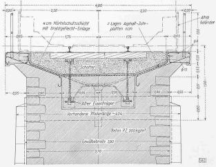
Abb. 5. Querschnitt 1:60 (N. B. im Bereich der Auskragung PZ 300)
