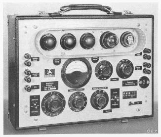
Abb. 31. Verstärkerprüfgerät, Vorderansicht
