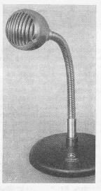
Abb. 20. Kommandomikrophon mit Gehäuse und Hals
