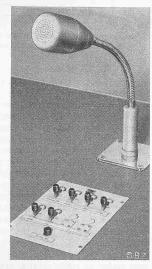
Abb. 21. Nebensprechstelle mit Mikrophon u. Bedienungsplatte
