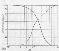
Abb. 18. Verständlichkeit in % in Funktion der Frequenzganggebiete bei Frequenzgangbeschneidung — — obere, — untere Grenzfrequenz
