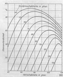
Abb. 5. Silbenverständlichkeit in % in Abhängigkeit von der Nutzschallstärkebei verschiedenen Störlärmschallstärken. Der Störlärm besitzt ein kontinuierliches Spektrum des Sprachfrequenzgebietes
