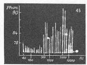
Abb. 16. Aus Bremsventilen ausströmende Luft
