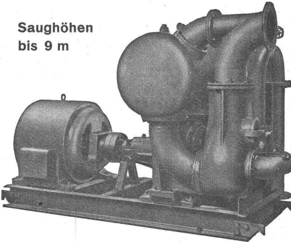
Leistungen 1 bis 500 Liter/Sek. Kein Bodenventil. Keine Klappe im Saugstutzen. Keine Hilfs-Vakuum-Pumpe. Jederzeitiges automatisches Ansaugen auch nach Luft-eintritt im Saugrohr. Keine reibenden, sich abnutzenden Dichtungsflächen, daher unempfindlich, gegen Sand, Schlamm und Kies.
