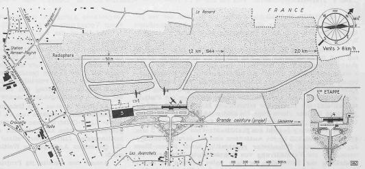
Abb. 10. Lageplan des Flugplatzes, 1:20000. Piste bis 1,2 km fertig, bis 2 km im Bau. Hochbauten projektiert. 1 heutiges, 4 zukünftiges Aufnahmegebäude; 2 heutige, 3 zukünftige Flugzeughallen
