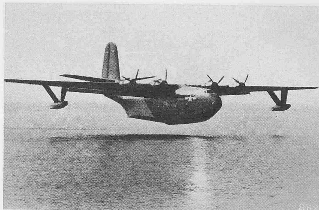
Abb. 11. «Mars-Mammoth» von Glenn Martin, Wasserflugboot von 80 t mit vier Motoren von je 3500 PS Startleistung, 108 Passagiere
