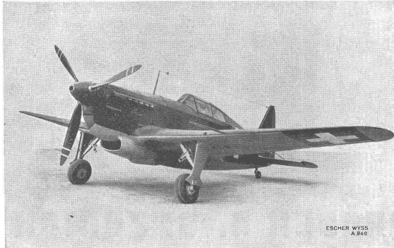
lösen die bisher von keiner Bauart erfüllte Aufgabe, mit dem Propeller beim Landen zu bremsen, was den Bremsweg auf einen Bruchteil herab- setzt
