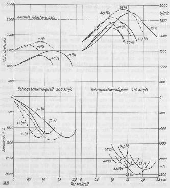
Abb. 23. Drehzahlverlauf und Bremskräfte in Abhängigkeit der Zeit beim Umstellen von Leerlauf auf Leistungsbremsung
