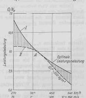
Abb. 32. Leistungsbelastungen: I bei optimaler, II bei konstanter Flächenbelastung
