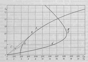
Abb. 28. I Polare eines zweimotorigen Tiefdeckers, II Werte  $1/\varepsilon$  in Abhängigkeit von  $c_{\rm a}$
