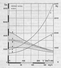
Abb. 24. Schubverbesserung durch Anwenden startverbessernder Mittel: A Schubkräfte eines normalen dreiflügligen Propellers. E entspr. Bremskräfte (Leistungsbremsung), B vierflügliger Propeller mit breiten Flügeln, C normaler dreiflügliger Propeller mit um rd. 10% erhöhter Startleistung und Startdrehzahl und vergrössertem Durchmesser. D dasselbe für einen vierflügligen Propeller, F zu D entspr. Bremskräfte. Motorleistung 1000 PS
