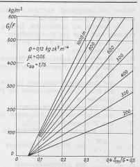
Abb. 26. Für den Start auf Hartbelagpiste zulässige Flächenbelastungen in Abhängigkeit des Schubfaktors bei gegebenen Rollstrecken
