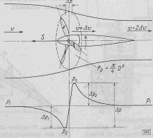
Abb. 3. Zur Strahltheorie des Propellers
