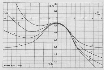
Abb. 18a. Werte  $C_{\delta} = \frac{2S}{\varrho v^2 F}$  für positive (Kurve h) und negative (Kurven\_b, d und f) Umfangsgeschwindigkeiten
