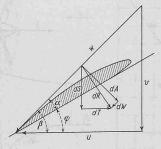
Abb. 8a. Propeller als Windmühle. Mit der Anströmrichtung wechseln die Luftkräfte; die Umfangskraft treibt den Propeller an
