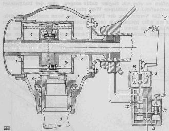
Abb. 5. Regulierschema des Escher Wyss-Verstellpropellers. 1 Servomotorzylinder, 2 Zentralrohr, 3 Propellernabe, 4 u. 5 Arbeitsräume, 6 Lenker, 7 Blatthalter, 8 Flügel, 9 Fliehkraftregler, 10 Feder, 11 Drehzahlverstellvorrichtung, 12 Steuerschieber, 13 Druckölpumpe, 14 Blockierventil, 15 Blockiervorrichtung, 16 Hubbegrenzvorrichtung
