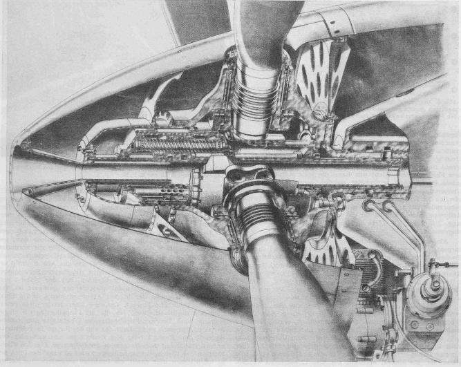
Abb. 6. Schnitt durch die Nabe eines Escher Wyss-Verstellpropellers
