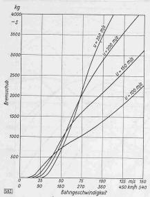
Abb. 16. Bremskräfte des flachgestellten leerlaufenden, vierflügligen Propellers von 3.1 m Durchmesser
