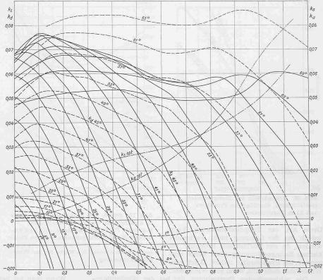
Abb. 12. Schubbeiwerte  $k_s$  (ausgezogen) und Drehmomentenbeiwerte  $k_d$ (gestrichelt) eines vierflügligen Modellpropellers im Bereich positiver Blattwinkel
