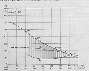
Abb. 15. Schubkräfte eines vierflügligen Verstellpropellers von 3,1 m Durchmesser in Abhängigkeit der Bahngeschwindigkeit bei N=1000 PS, u=250 m/s,  $\varrho=0.09$  kg s²/m⁴ (rd. 3000 m Höhe). S. Standschub am Boden, S. Schubkräfte des gleichen Propellers bei fester Blattstellung entsprechend einer Reisegeschwindigkeit von 160 m/s. W Luftwiderstand des zugehörigen Flugzeuges. A Betriebspunkt bei stationärem Horizontalflug u. voller Leistung
