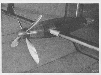
Abb. 10. Vierflügliger Modellpropeller im Windkanal des Institutes für Aerodynamik an der E. T. H.
