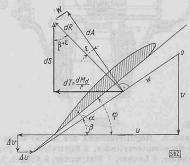
Abb. 4. Kräfte und Geschwindigkeiten am Blattelement
