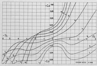
Abb. 18b. Werte  $C_d = \frac{2\,M_d}{\varrho\,\,v^2\,F\,R}$  für positive (Kurven g bis i) und negative (Kurven a bis f) Umfangsgeschwindigkeiten
