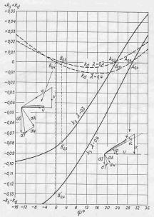
Abb. 17. Schub- und Drehmomentenbeiwerte in Abhängigkeit des Blattwinkels  $\varphi$  für konstante Fortschrittsgrade ( $\lambda=0.3$  und 0,4). A obere Stabilisierungspunkte ergeben kleine  $k_s$ -Werte A'. B untere Stabilisierungspunkte ergeben die grossen  $k_s$ -Werte B' der Windmühlenbremsung
