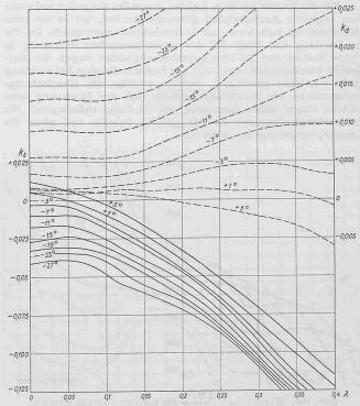
Abb. 13. Schub- und Drehmomentbeiwerte eines vierflügligen Modellpropellers im Bereich der Windmühlen- u. Leistungsbremsung
