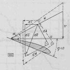
Abb. 8b. Propeller als Leistungsbremse. Umfangskraft u. Bremsschub wachsen mit der Bahngeschwindigkeit
