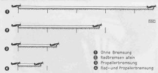
Abb. 9. Gemessene Ausrollstrecken bei der Landung eines modernen Jagdflugzeuges veranschaulichen die Wirksamkeit der Leistungsbremsung mit dem Propeller
