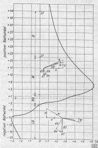
Abb. 20. Durch Modellversuche bestimmte Stabilisierungspunkte (Werte  $1/\lambda = u/v$ ) in Abhängigkeit des Blattwinkels für  $k_d = 0$ . R positiver Regulierbereich; W Windmühlenbereich, der rasch zu durchlaufen ist; WB Windmühlenbremsbereich; LB Leistungsbremsbereich
