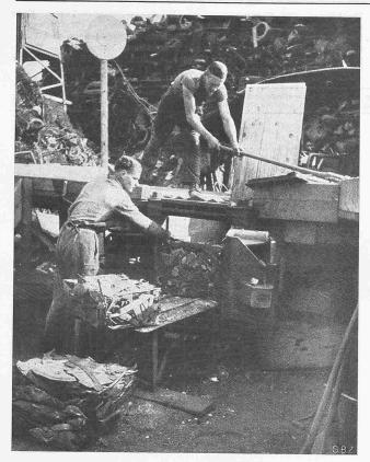
Abb. 2. Ausstoss aus der Schrott-Paketierpresse
