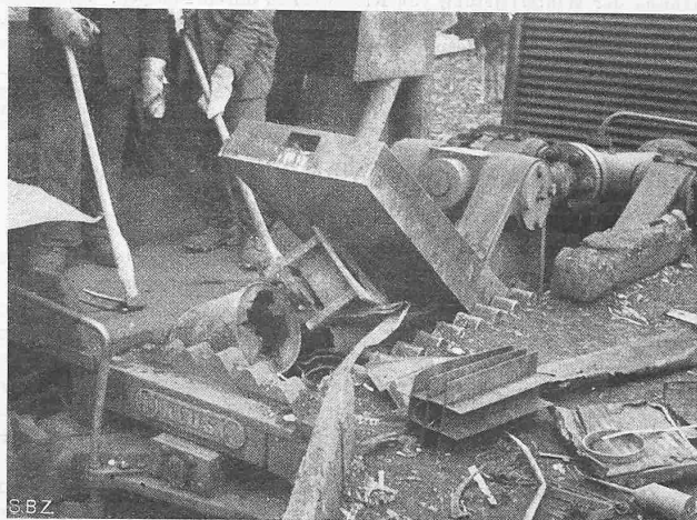
Abb. 1. Füllschacht einer Schrottpresse
