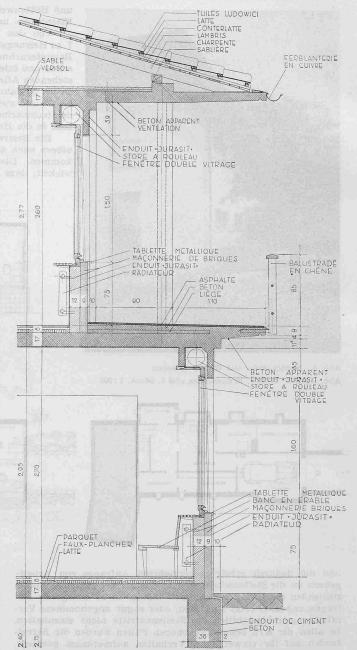
Abb. 7. Querschnitt der Südfassade, 1:40
