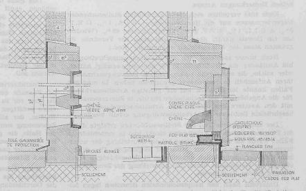
Abb. 9. Glaswand bei der Haustüre, Grundriss-Details 1:5
