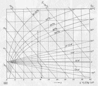
Abb. 2. Diagramm zur Bestimmung der absoluten Feuchte  $\boldsymbol{x}$  aus den Ablesungen des Trocken- und Feuchtthermometers und dem Barometerstand nach B. Koch
