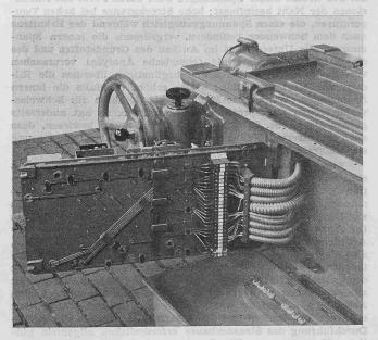
Abb. 3. Aufgeklappter Steuerkasten mit leicht zugänglichen Kabelanschlüssen
