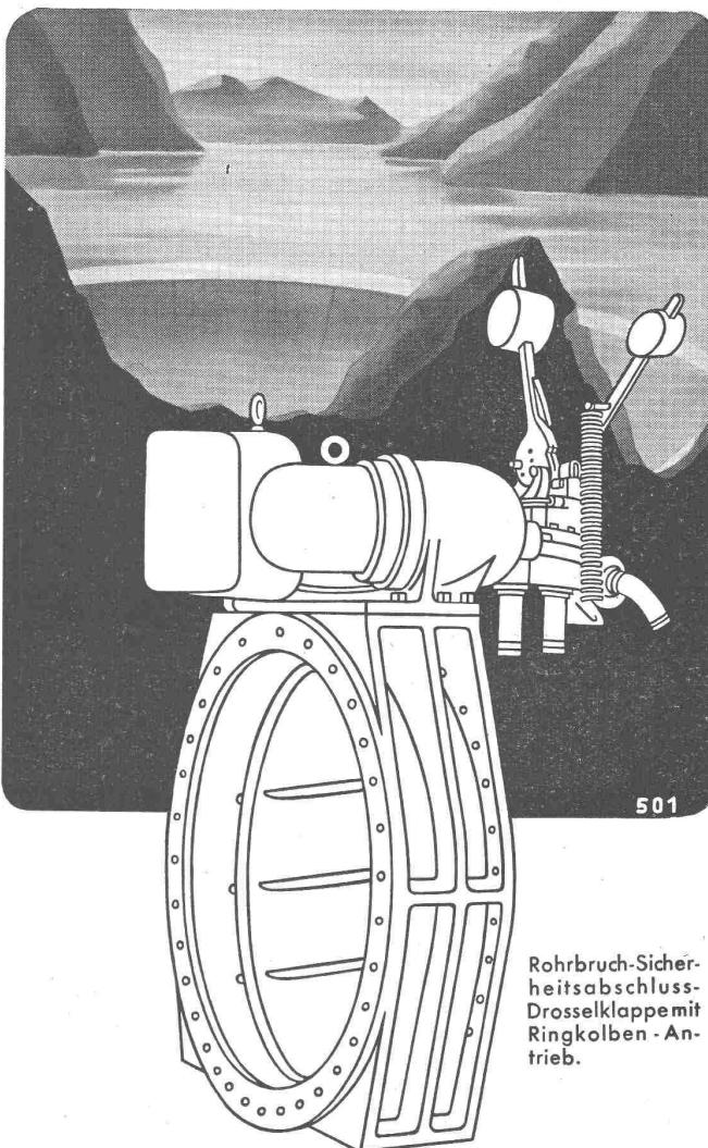
Rohrbruch-Sicherheitsabschluss-Drosselklappe mit Ringkolben - Antrieb.
