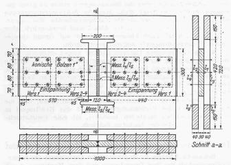
Abb. 1. Einspannrahmen für Schweissversuche
