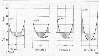
Abb. 3. Schweisspannungen bei ungehinderter Längenänderung
