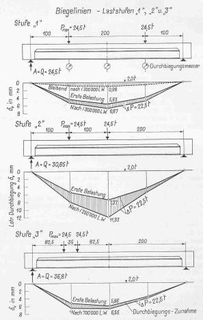
Abb. 15. Verbundträger Nr. 4. Ermüdungsversuch
