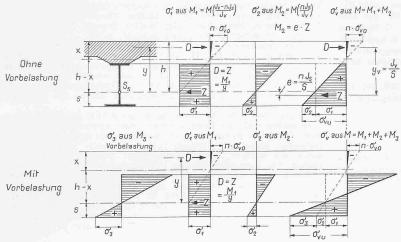
Abb. 16. Spannungsdiagramm des Verbundträgers
