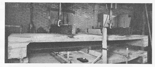
Abb. 14. Verbundträger Nr. 3. Biege-Ermüdungsversuch im Amsler-Pulsator
