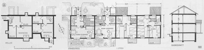
Abb. 6. Grundrisse und Schnitt der Vierhäusergruppen Typ A
