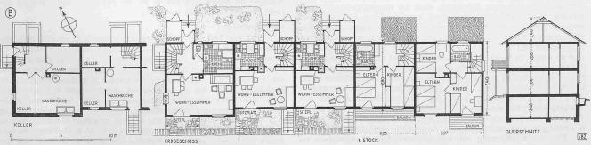
Abb. 7. Grundrisse und Schnitt der Fünfhäusergruppe, Typ B
