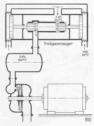
Abb. 13. Schema einer Treibgaserzeugeranlage
