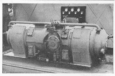
Abb. 14. Pescara-Treibgaserzeuger von 1500 PS
