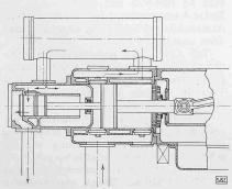
Abb. 10. Kompressor eines zweistufigen Flugkolben-Kompressors für 35 at
