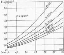
Abb. 12. Spannungen infolge gleichmässiger Temperaturänderung  $t=40^{\circ}$
