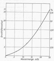
Abb. 1. Gemessener Druckhöhenverlust im Zuleitungstollen und Druckschacht in Abhängigkeit der Wassermenge, umgerechnet auf das Gesamtgefälle von 670 m
