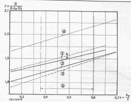
Abb. 3. Ergebnisse der verschiedenen Wassermessungen. 1a Ueberfall Rehbock 1929,
