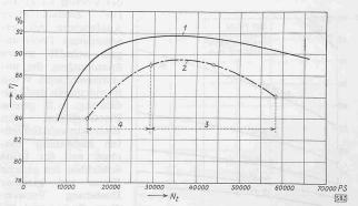
Abb. 6. Turbinenwirkungsgrad, umgerechnet auf ein Nutzgefälle von 670 m und n=428,6 U/min. 1 Gemessener Wirkungsgrad, 2 Garantierter Wirkungsgrad, 3 Garantiebereich, 4 Zur Information angegebener Verlauf des Wirkungsgrades
