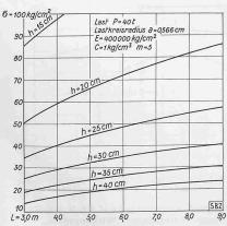
Abb. 14. Spannungen infolge  $P=40\,\mathrm{t}$  in Plattenmitte
